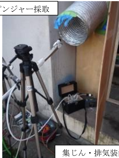
集じん・排気装置（2台）と 作業場所濃度測定（インピンジャー採取）
