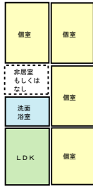
1. リビングを配する主たる方位に個室が1室、主たる方位以外に個室が3室(外気に面する面に2室、内側に1室)水周りが中央部。片廊下型に見られる N=30
