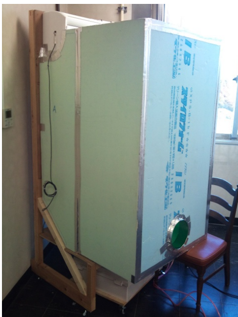
図 7.2.6.3 風量測定ボックスを取り付けたところ
