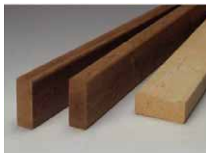
サーモウッド:熱処理によって腐朽菌の付着を防ぐ効果のある木材(右は処理前のパネル)
