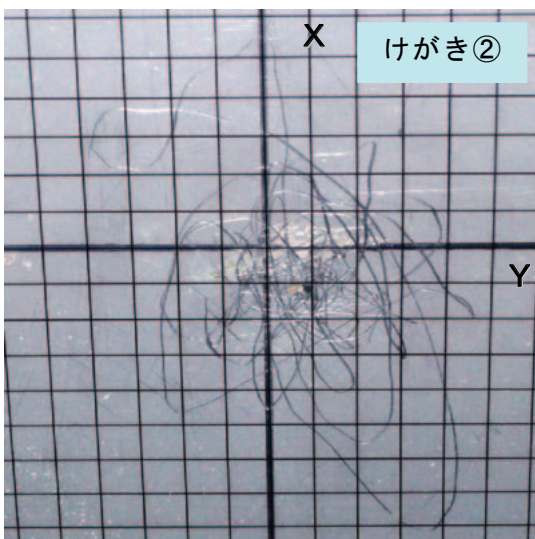
図-8.5.9 けがき変位計による本震の応答変位オービット (5mmグリッドを重ねて撮影)
