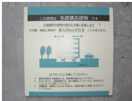
(b) 免震であることの表示（最大変形量55cm）
