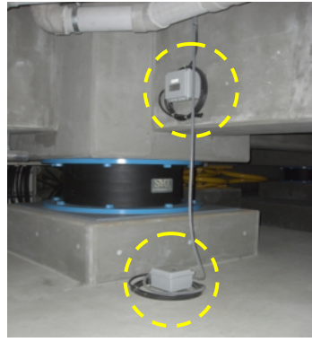
(a) 収録装置 (Akashi製SMAC-MDU) (b) 地震計設置状況 (免震層内)
