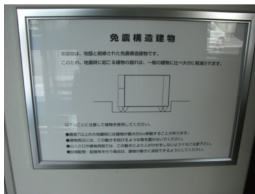
(b) 免震であることの表示（最大変形量50cm）
