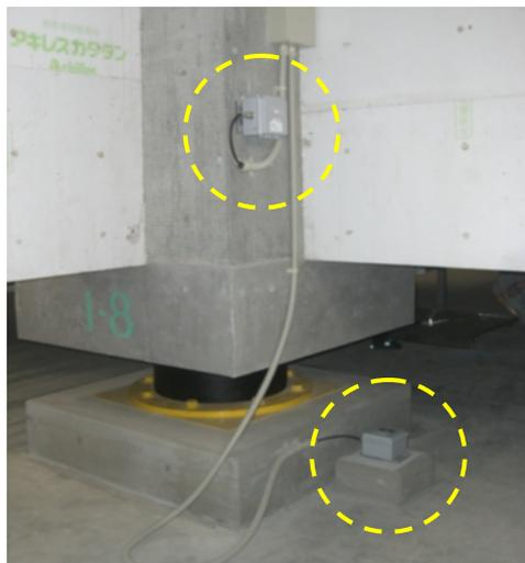
図-5.4.2 免震層内の強震計設置状況
