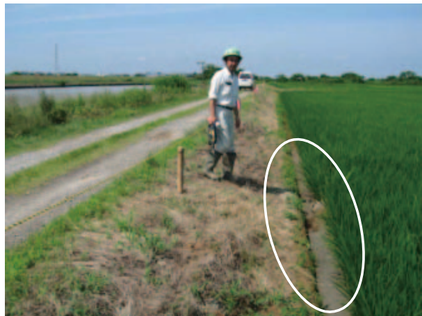
写真-5.8 管理用通路脇の耕作地に生じた噴砂（下流側から上流側を望む）
