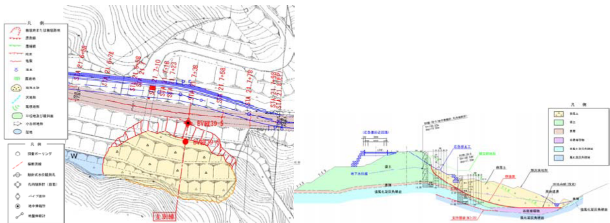
図-7.2.36 崩壊箇所平面図及び主断面図 その3 (能登有料 穴水町越の原その2 21.7kp 縦-39) 2)
