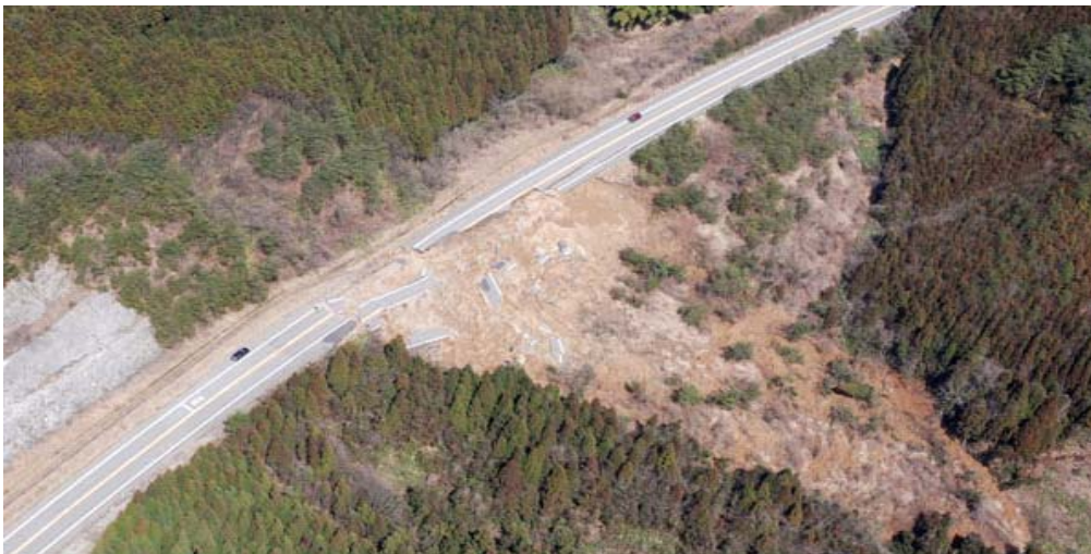
写真-7.2.22 被災箇所の航空写真（能登有料 穴水町越の原その1 21.1kp 縦-38）（石川県提供） 1)
