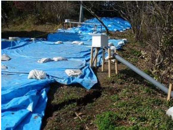
15-c 伸縮計による計測
