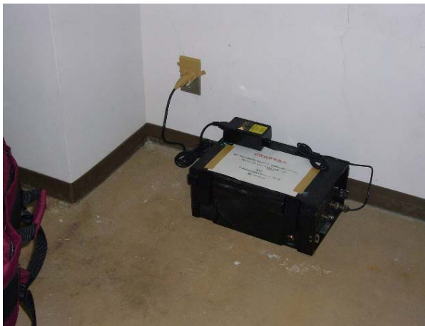
写真-3.7 門前支所地下1階強震計設置状況
