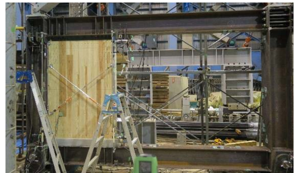
写真 4 鉄骨フレームと CLT 耐震壁の併用構造のせん断実験
