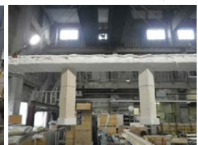
図 2 耐火試験(柱)の様子
