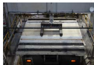
図 1 耐火試験(床)の様子
