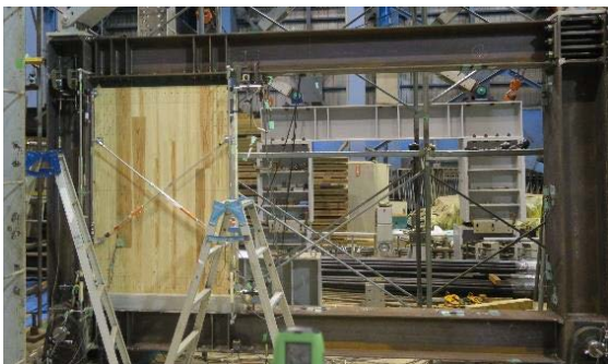
写真 2 S+CKT の構面実験
