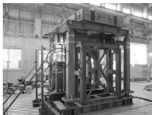
写真 1 振動台実験の加振装置全景
