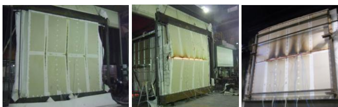
a) S2(熱応力) b) S4(強制変形) c) S7(非拘束) 図 4 非拘束・熱応力・強制変形時の損傷状況
