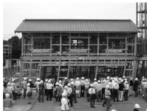
写真 1 実大静的加力試験－A棟の大変形時の様子
