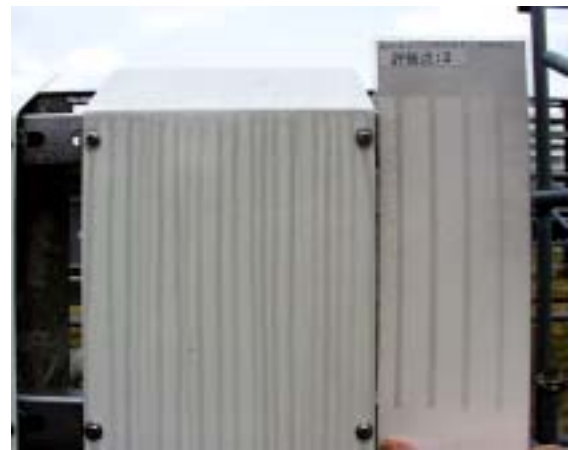
図 1 屋外暴露試験体および雨筋評価見本帳
