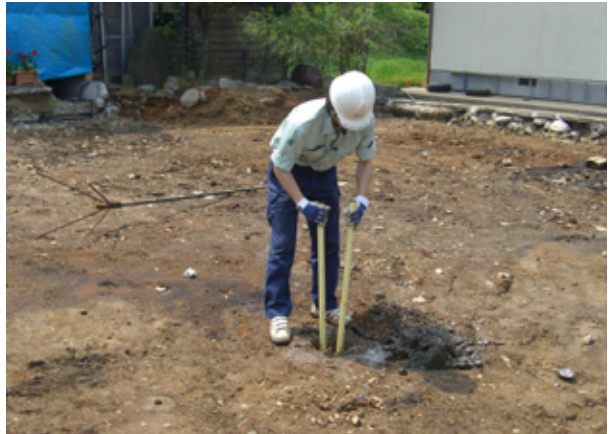
写真-1 地震被害により解体撤去された住宅の敷地での地盤調査 (左：表面波探査、右：土質試料採取)
