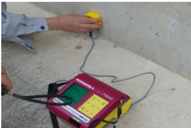
写真-10 鉄筋計による基礎コンクリートの配筋等の調査 上段上：昨年建設された鉄筋コンクリート造の住宅
