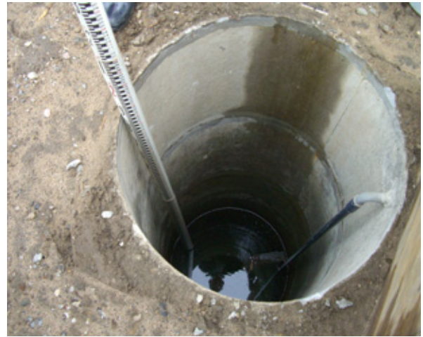
写真-19 地下水の測定状況（輪島市門前道下地区）
