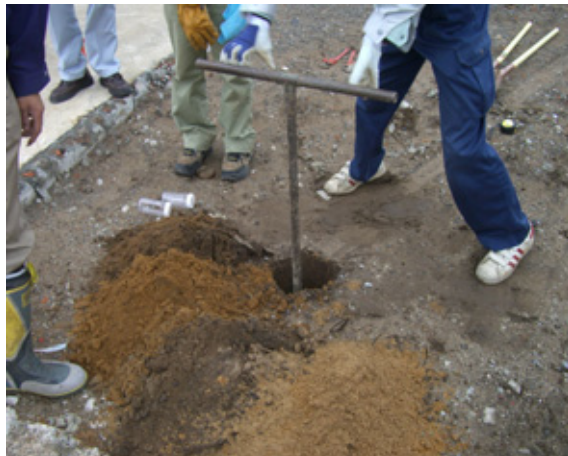
写真-18 土質試料の採取（輪島市門前町道下地区）
