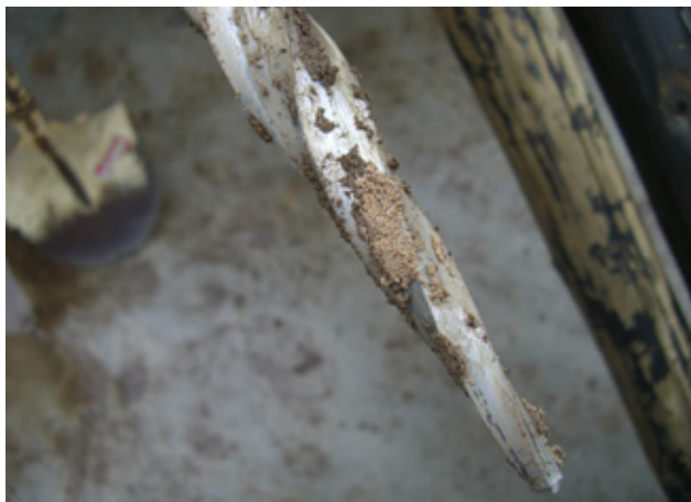
写真-17 スウェーデン式サウンディングと土質試料の採取 (輪島市門前道下地区)
