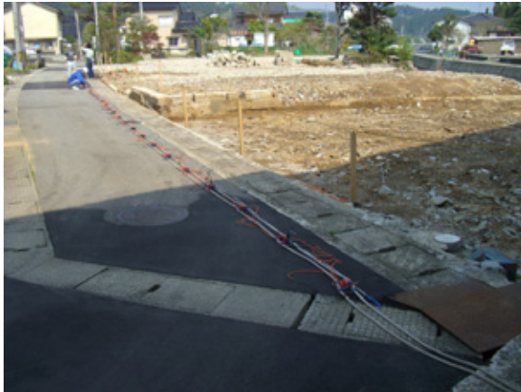
写真-1 地震被害により解体撤去された住宅の敷地での地盤調査 (左：表面波探査、右：土質試料採取)
