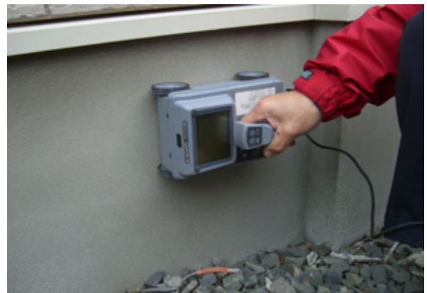
写真-10 鉄筋計による基礎コンクリートの配筋等の調査 上段上：昨年建設された鉄筋コンクリート造の住宅
