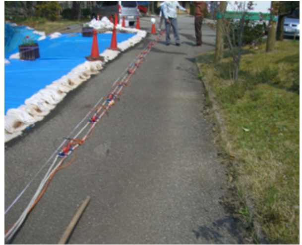
写真-23 谷埋め盛土の崩壊地における地盤調査
