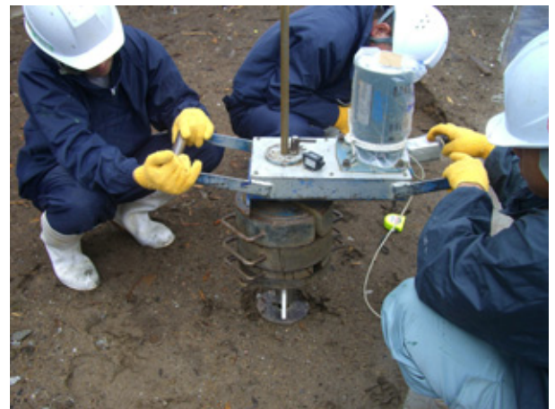
写真-17 スウェーデン式サウンディングと土質試料の採取 (輪島市門前道下地区)
