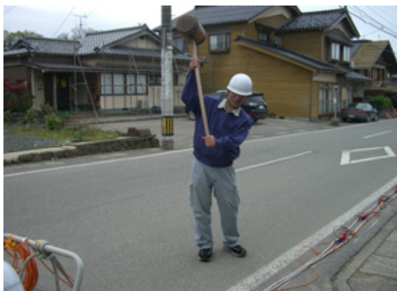
写真-15 表面波探査の実施状況（輪島市門前道下）
