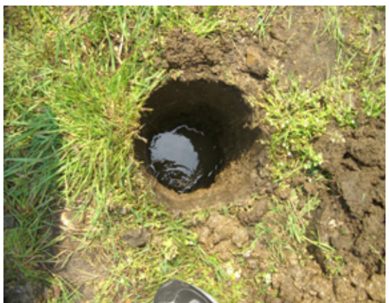
写真-22 スウェーデン式サウンディングと土質試料の採取（穴水町） 最下段左：粘土中に含まれる木くずなど 最下段右：地下水位観測（表層水の地下水位はGL-40cm程度）
