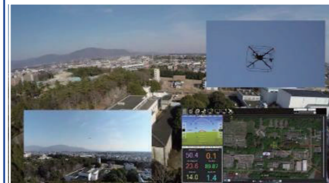
ドローンに搭載されたカメラによる被災状況解析システムの開発 Development of a system for analyzing the damage situation using a camera mounted on a drone
